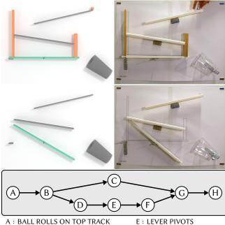
A : BALL ROLLS ON TOP TRACK B : BALL HITS LEFT PLANK C : BALL ROLLS ON BOTTOM TRACK
